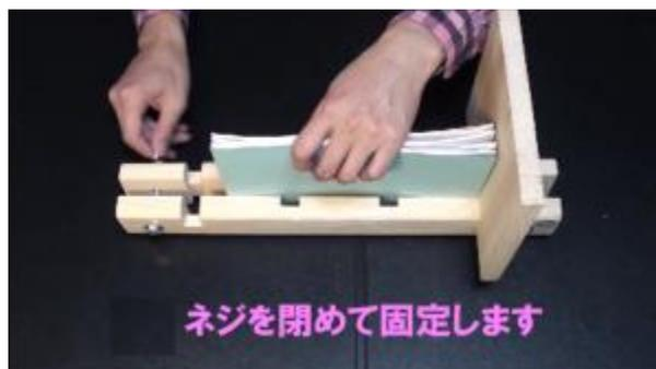
ネジを締めて原稿を固定します
