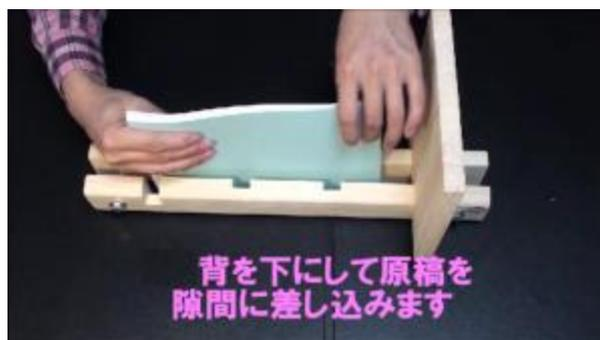
背を下にして原稿を隙間に差し込みます
