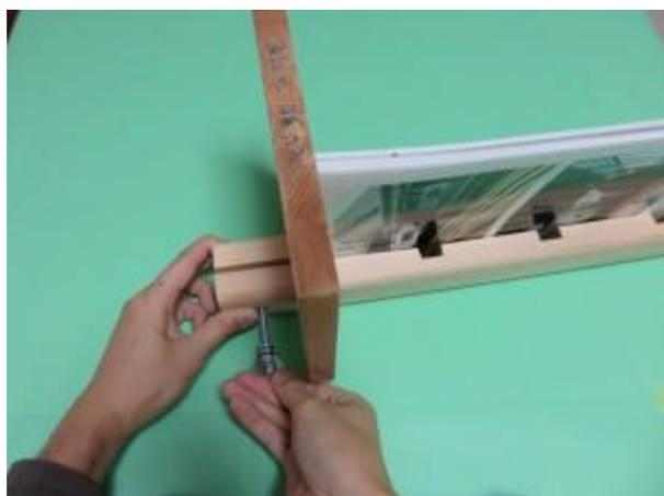
片手で締め板をしっかり押さえて、もう片方の手でネジを締めます。
