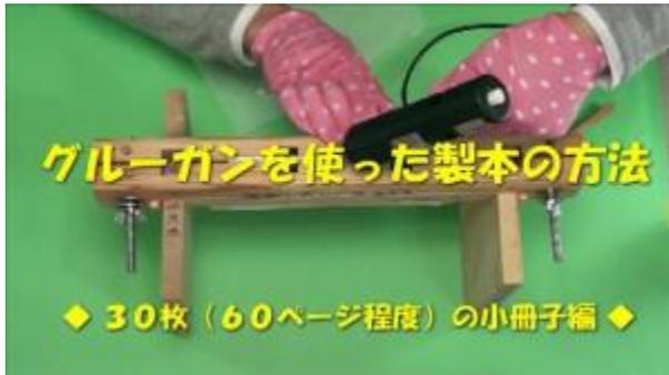
30枚(60ページ)程度の小冊をグルーガン(ホットメルトガン)を使って製本する方法です。グルーガンを使って製本するメリットは、薄い冊子の背に確実にホットメルトをのせることができます。
