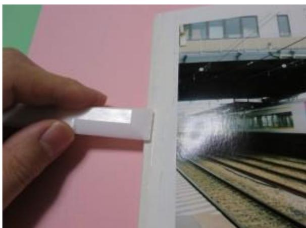
ボンド用のヘラで約5ミリの幅になるように延ばします。
