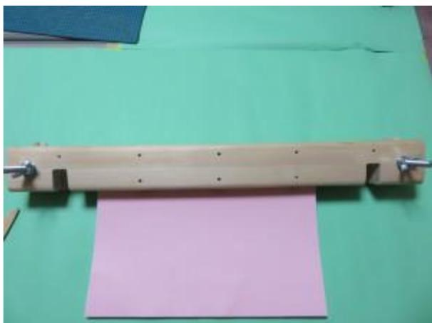
両面とも貼り付けたら、製本機で締めて乾くのを待ちます。
