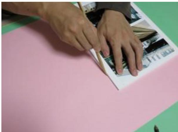
折りヘラの先の尖った方の平らな面を小口（背の反対側）に沿わせて紙に筋をつけます。
