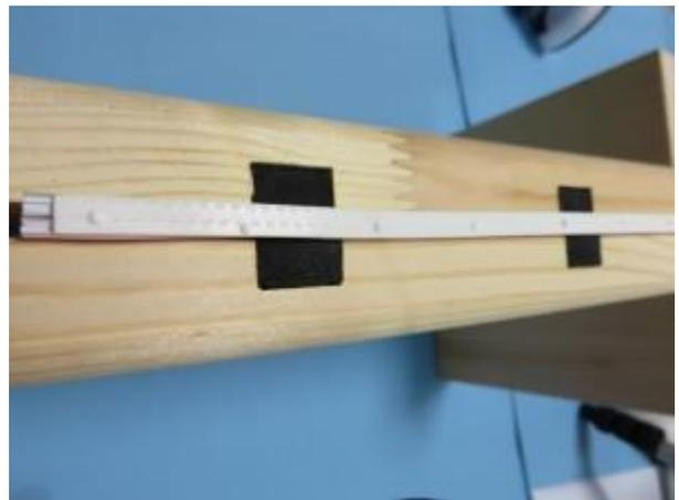
5センチ程度の間隔でボンドで点を打ちます。
