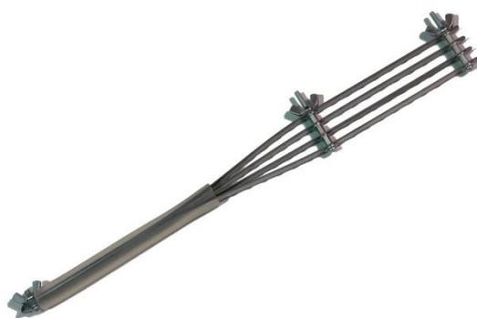
背固めをする際に、ホットメルト（背糊）の接着面積を増やすために、背に溝を入れる工具です。右は4枚刃で一気に4本の溝が切れる「溝切り名人」です。溝切り工程が楽に短時間でできます。
