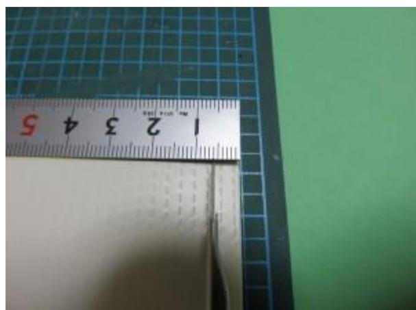
ホットメルトシートを6ミリの幅で切るために、カッターで6ミリのところに印をつけます。
